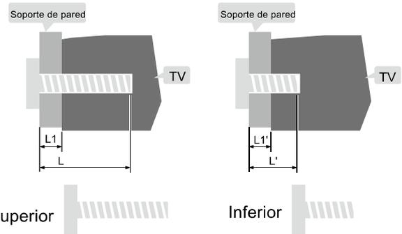
L1: Espesor del soporte de pared      L1': Espesor del soporte de pared
